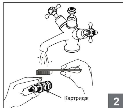
Встроенные термостатические картриджи работают бесперебойно, а в случае неисправности, их сервисное обслуживание просто.
