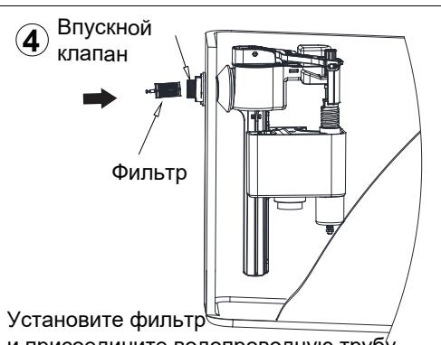
Установите фильтр и присоедините водопроводную трубу.
