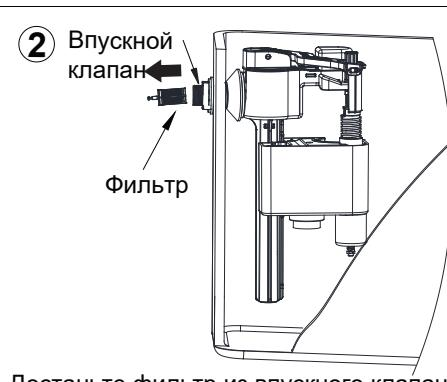
Достаньте фильтр из впускного клапана
