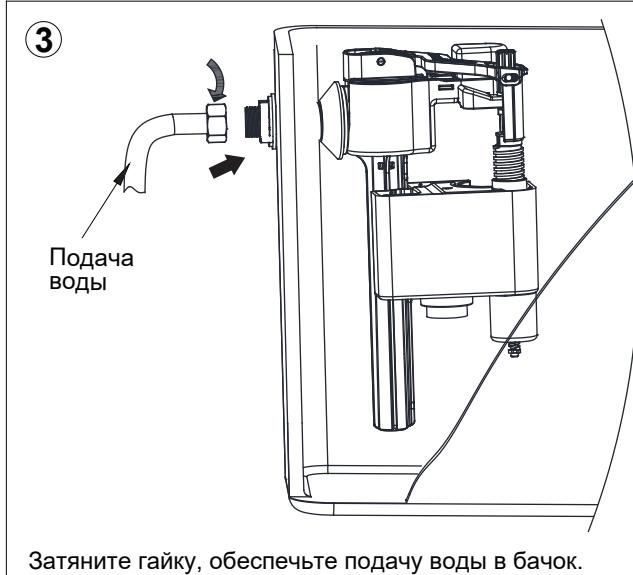
Затяните гайку, обеспечьте подачу воды в бачок.
