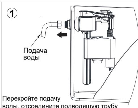
Перекройте подачу воды, отсоедините подводящую трубу
